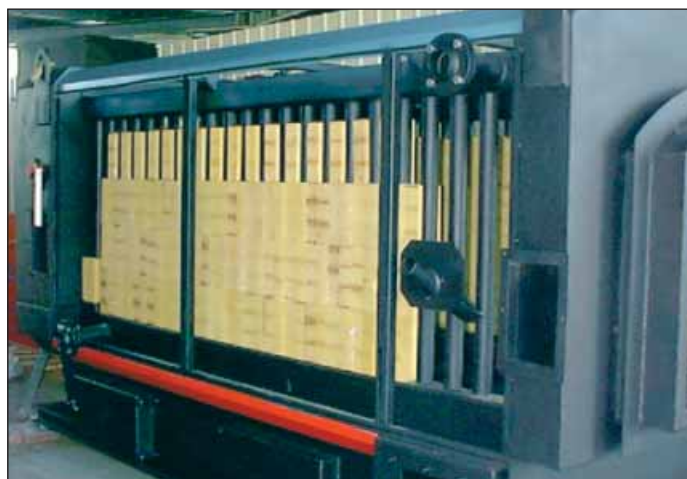
Minimiert Abstrahlverluste – das Kühlrohrsystem
