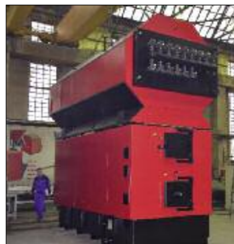
Ein TRF-RK Kessel fertig zum Versand
