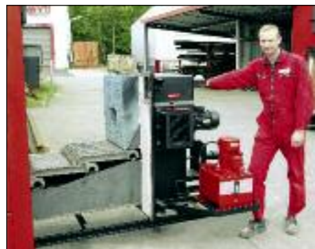
Mit wenigen Handgriffen ist die Feuerung ausgefahren.
